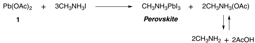
Scheme 1. 酢酸鉛から CH 3 NH 3 PbI 3 への生成機構 2)
